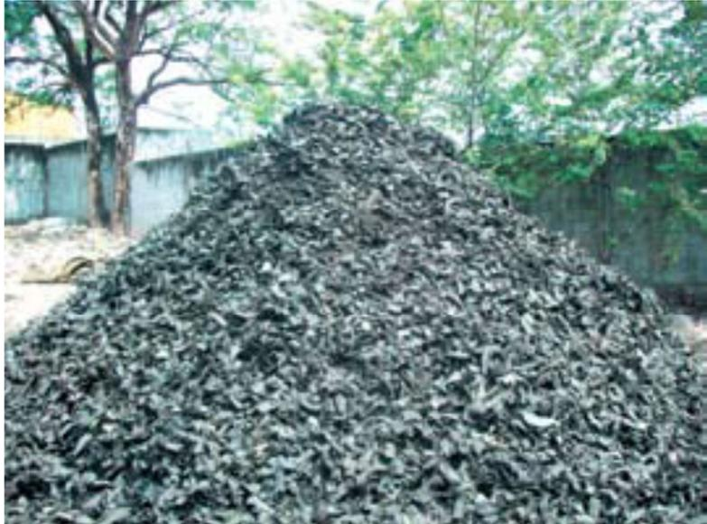
**Figura 62: Pneus processados para utilização em forno de clínquer.**
