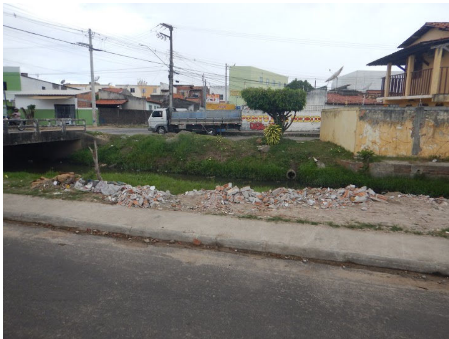
Figura 29: RCC acumulados em via pública – Aracaju/SE
