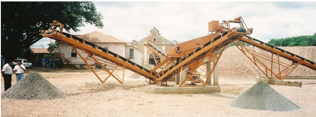
Figura 13: Fotografia de uma unidade de reciclagem de RCC, Piracicaba-SP.
