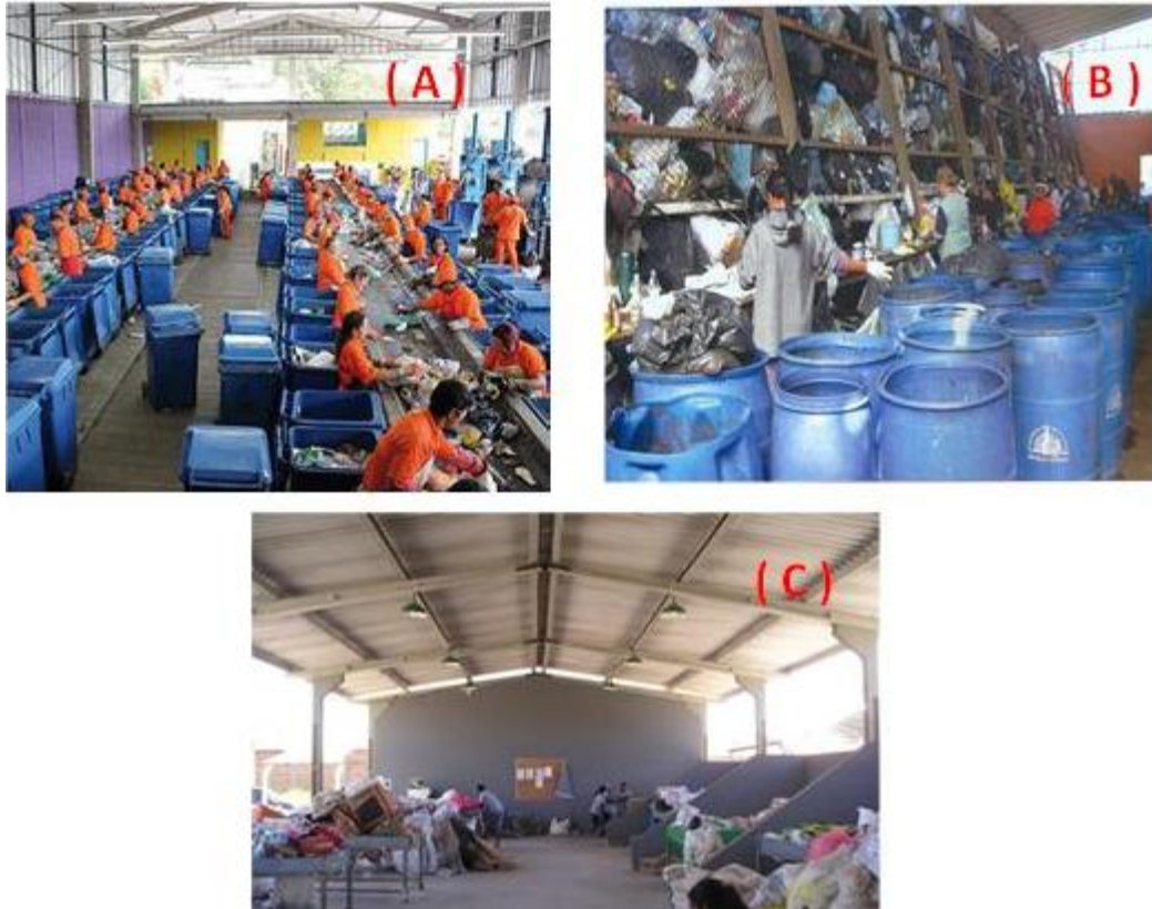
Figura 6: Fotografias mostrando setores de segregação de resíduos em diferentes Galpões de Triagem. (A): Modelo com uso de esteira, Coopervivabem-Bairro da Lapa–São Paulo/SP (2012); (B): Fosso suspenso com aberturas na parte inferior, caso do Centro de Triagem da Vila Pinto, Porto Alegre (2013); (C): Caso de uso de bancadas ou mesas, na CARE, Aracaju-SE (2007).
